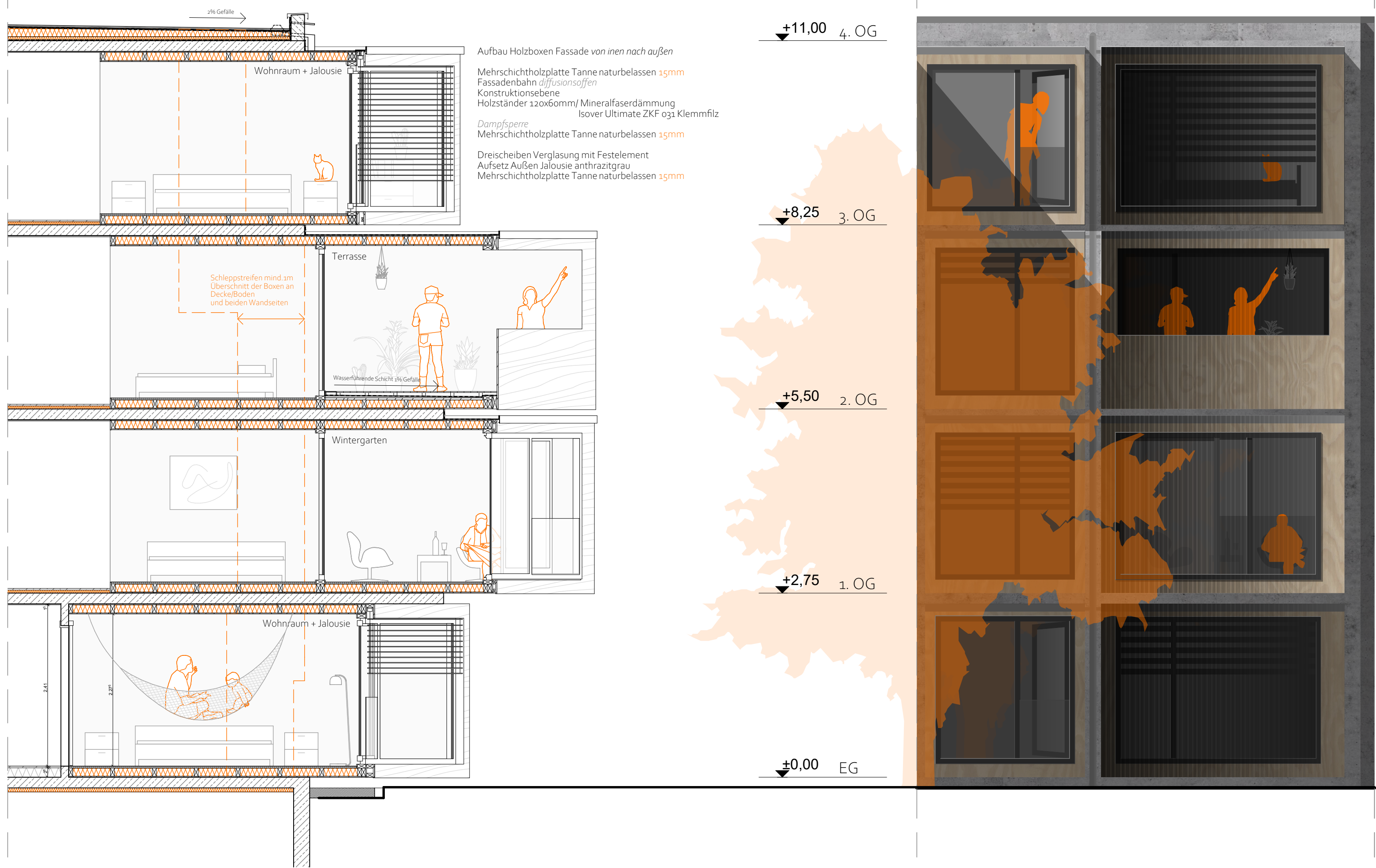
12 Fassadenschnitt 1:50: eingeschobene Holz Modul Boxen in Holzständerbauweise
